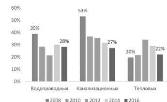
Рисунок 10 – Доля водопроводных, канализационных и тепловых сетей, нуждающихся в замене, в общей протяженности коммунальных сетей района, %
